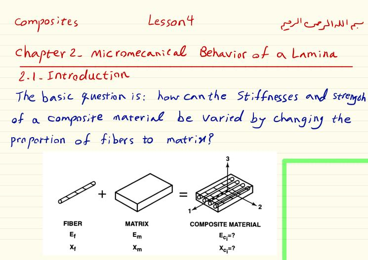
$$C_{ij} = C_{ij} (E_{f}, V_{f}, V_{f}, E_{m}, V_{m}, V_{m})$$
