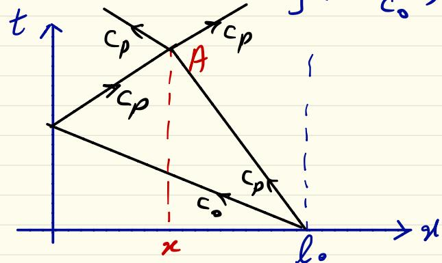
در نقطه A دو موج پلاستیک با هم برخوردی کنند که نتیجه آن انتشار دو موج پلاستیک است.
